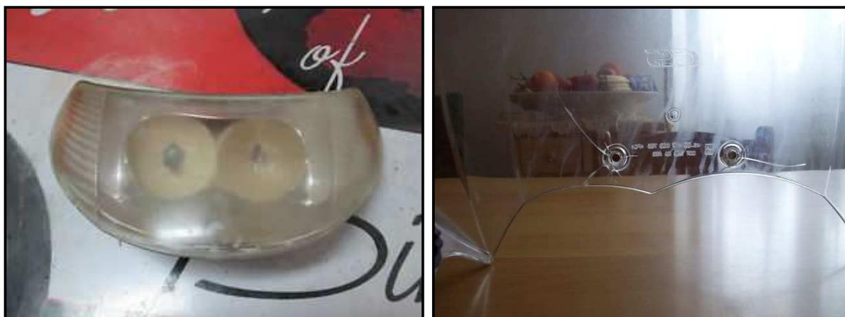
A sinistra un vecchio faro ormai opacizzato. A destra un plexiglass rotto a causa dell'eccessiva coppia delle viti.
