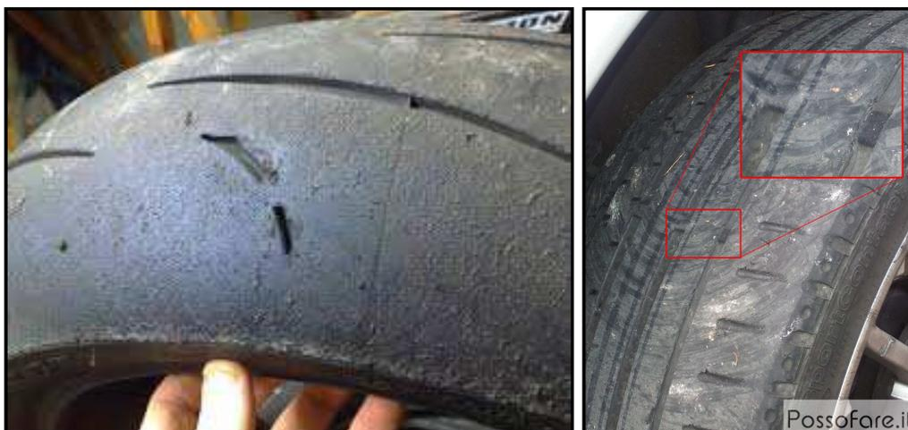
A sinistra esempio di gomma usata in pista. A destra esempio di tacca di legge (pneum. automobilistico).
